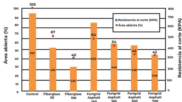
Figura 2. Resultados de ensayos de resistencia al corte AASHTO TP 114 y porcentaje de área abierta.
